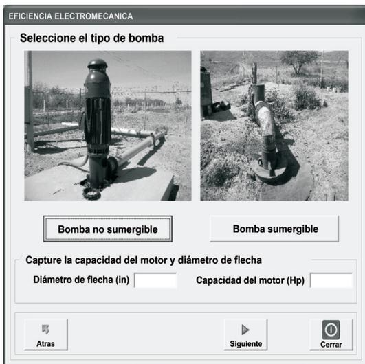
Figura 8. Campos para capturar capacidad del motor eléctrico y diámetro de flecha en bombas con motor externo.
