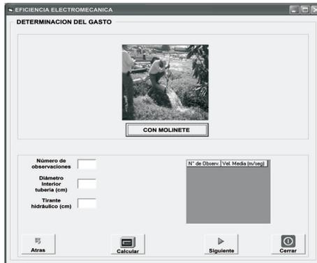
Figura 13. Ventana para determinar el gasto por la técnica del molinete (tubo parcialmente lleno).
