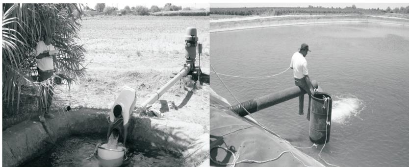
Figura 29. Determinación del gasto con la técnica del método volumétrico.
