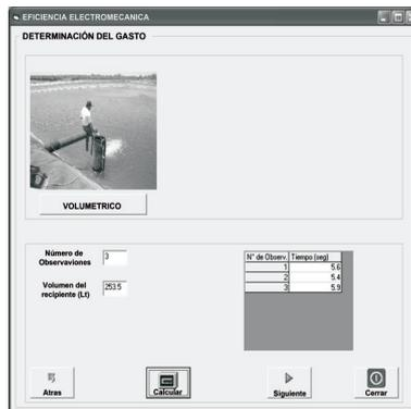
Figura 10. Ventana para determinar el gasto por la técnica del método volumétrico.
